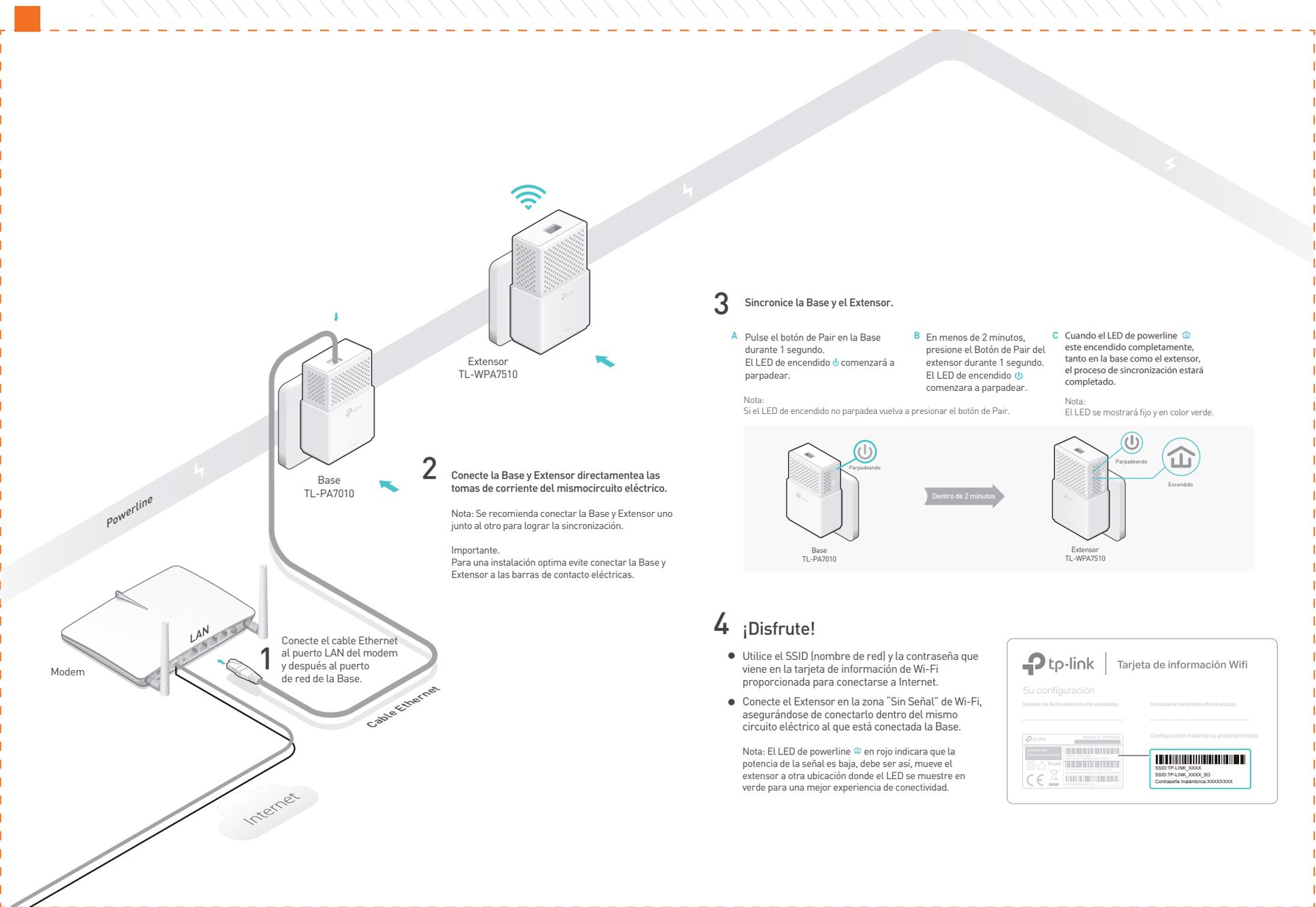
1 Conecte el cable Ethernet al puerto LAN del modem y después al puerto de red de la Base.
